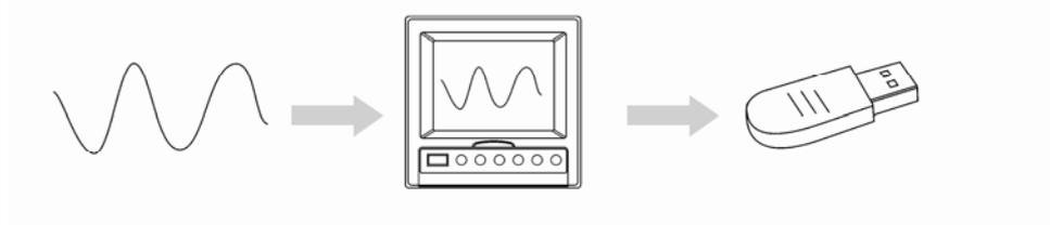
显示数据是仪表画面显示曲线和数显的数据。它是仪表从采样到的数据中筛选出来的。一个数据相当于曲线画面上的一个点，一个数据所代表的时间是由仪表的记录间隔所决定的。显示数据相当于原来的记录纸，对长时间观测很适合。
