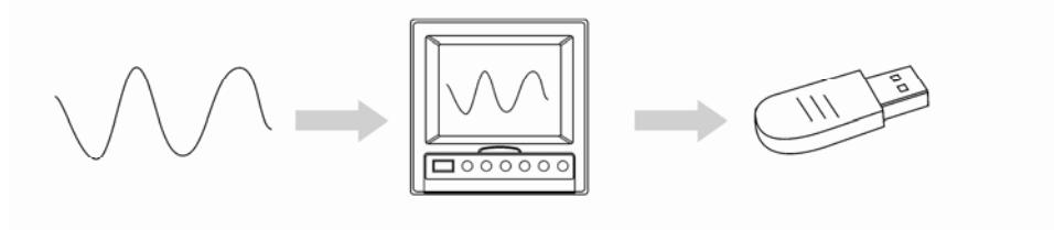
显示数据是仪表画面显示曲线和数显的数据。它是仪表从采样到的数据中筛选出来的。一个数据相当于曲线画面上的一个点，一个数据所代表的时间是由仪表的记录间隔所决定的。显示数据相当于原来的记录纸，对长时间观测很适合。
